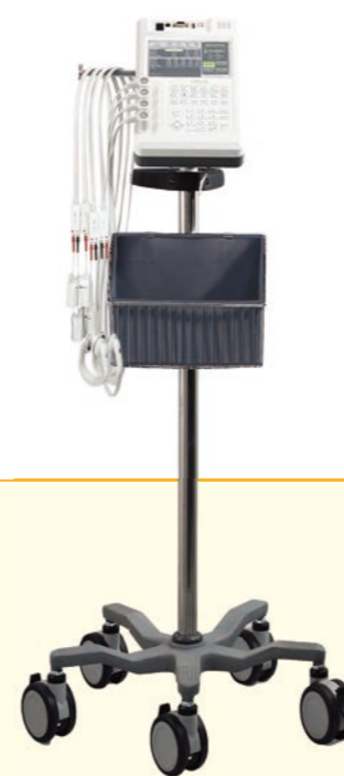
交流電流が流れる際の抵抗で水分量を測定するが、高周波数の電流は細胞膜を通過するようになる。
